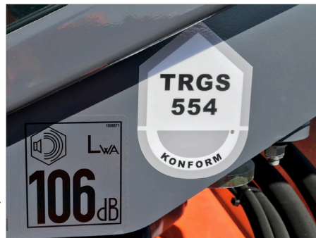
Maschine mit verpflichtender Schall-Kennzeichnung (106 dB) und freiwilliger Kennzeichnung mit Bezug auf die Abgase (TRGS 554)
